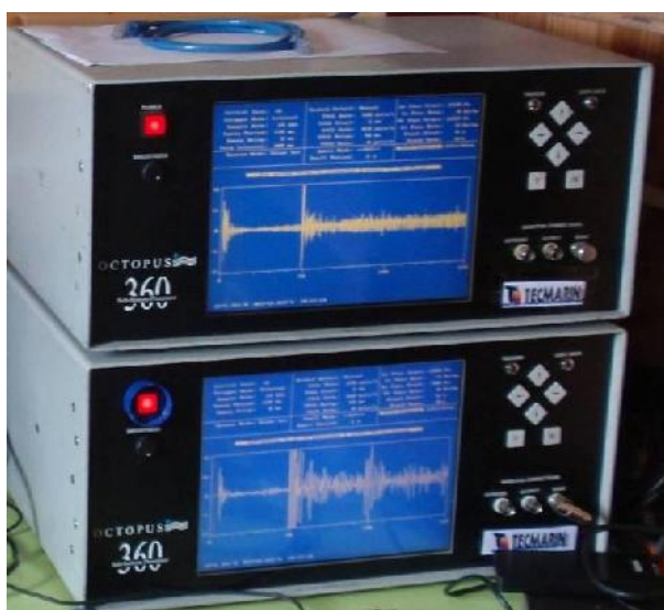
Figura 24. Procesadores de las señales sísmicas
