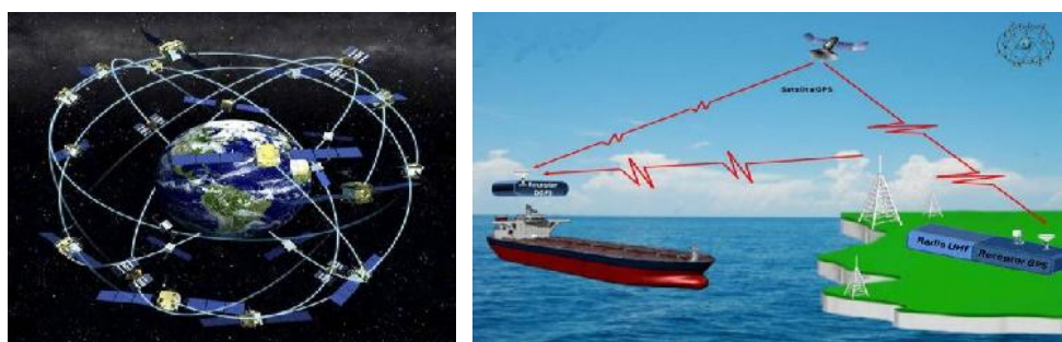
Figura 9. Imágenes con la constelación Navstar y un esquema de los tres segmentos que la componen.
