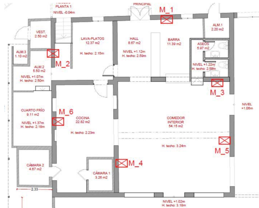
Figura 4. Situación catas en muros planta baja
