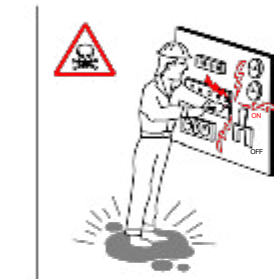
REPARACION DE EQUIPOS BAJO TENSION
