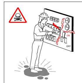
REPARACION DE EQUIPOS BAJO TENSION
