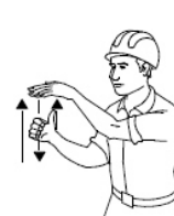
4 LEVANTAR EL AGUILÓN O PLUMA LENTAMENTE
