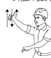
10 BAJAR EL AGUILÓN O PLUMA Y LEVANTAR LA CARGA
