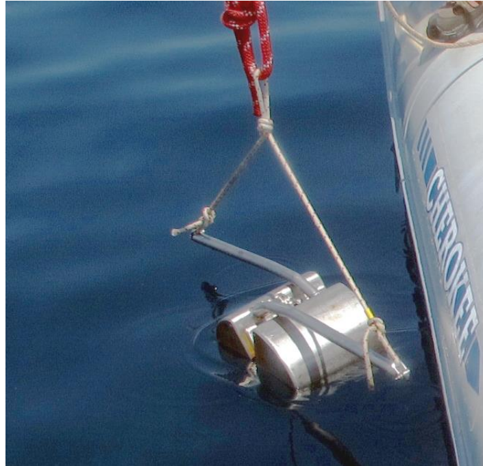
Draga Van Veen empleada en la toma de muestras superficiales.
