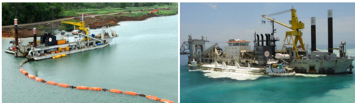
Figura 1. Sistema de vertido por tubería (izquierda) o mediante gánguil (derecha). Fuente: IADC
