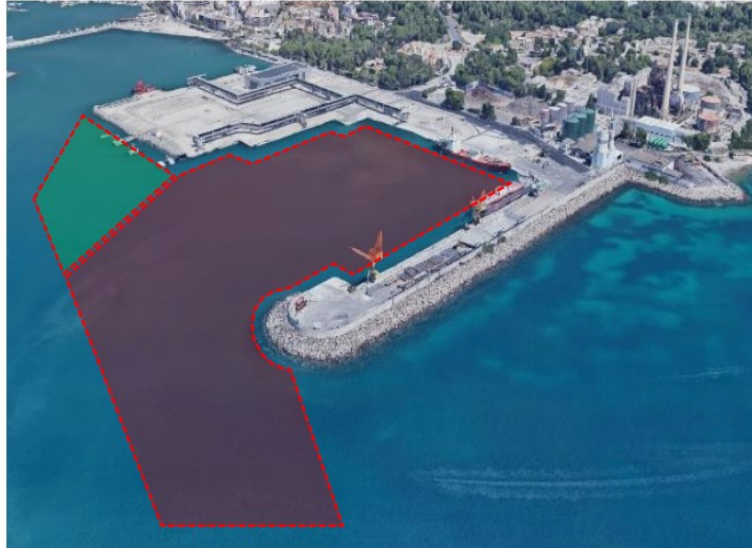
Figura 1: Definición de las dos zonas de dragado. En verde, la zona a dragar a una cota de -6,5 m; en rojo, la zona a dragar a -8,5 m. Fuente: documentación aportada por el promotor
