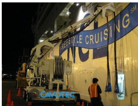
Figura 28. Pasar los cables hacia el barco
