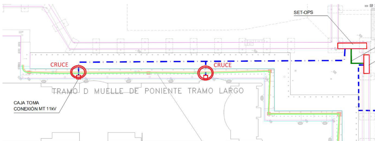
Figura 40. Servicios afectados. Cruce con canalizaciones de BT y tubería de agua potable
