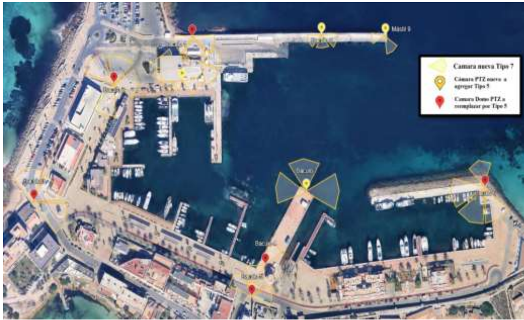
PROPUESTA DE UBICACIÓN DE LAS CÁMARAS A REEMPLAZAR Y NUEVAS A AGREGAR. GENERAL
