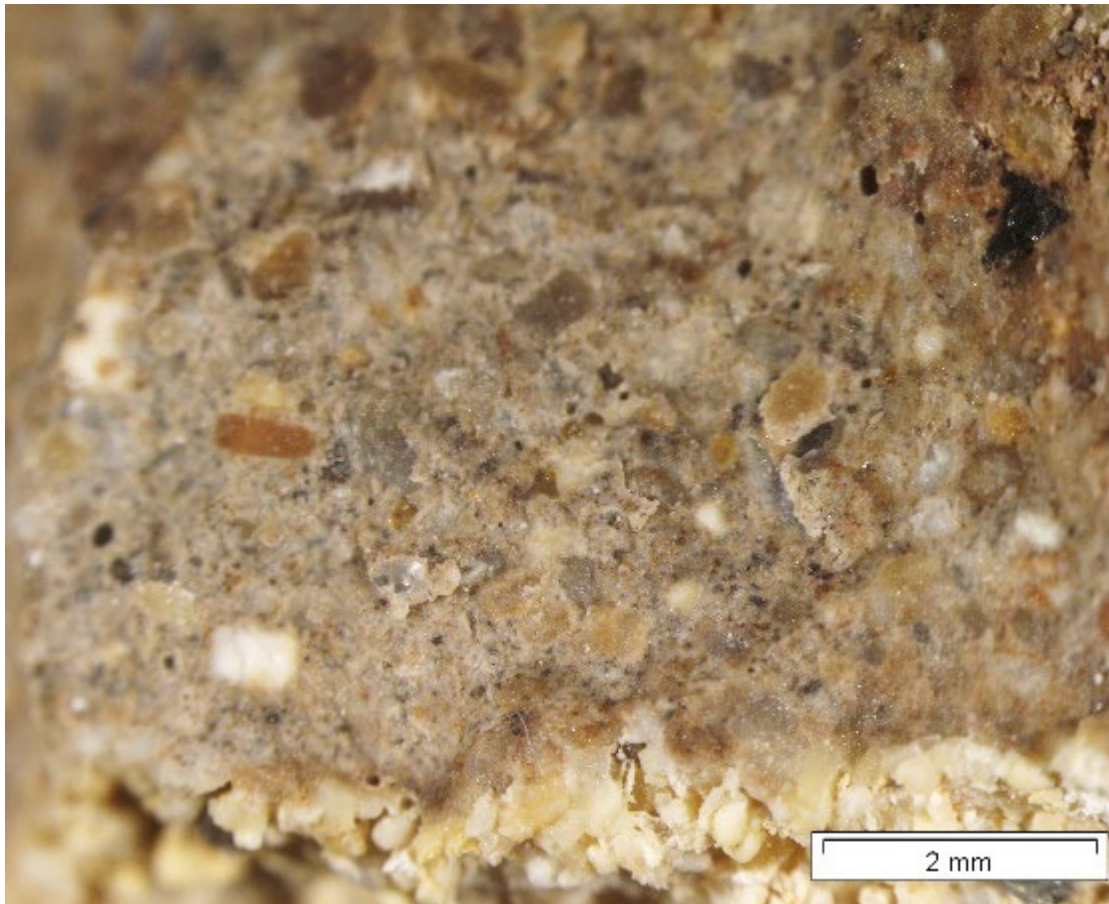
Figura 5.- General y detalle a la lupa binocular del mortero referenciado como MO-2.
