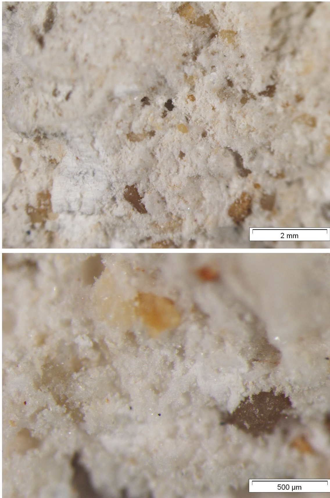
Figura 13.- Detalles a la lupa binocular del mortero blanquecino de la muestra M6-M7.
