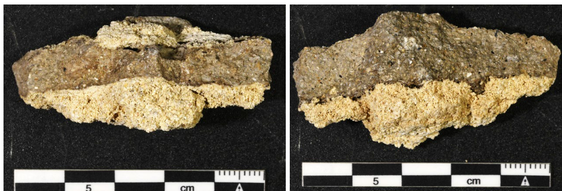
Figura 4.- Aspecto macroscópico de la muestra MO-2. Se observan dos materiales pétreos de aspecto diferente.
