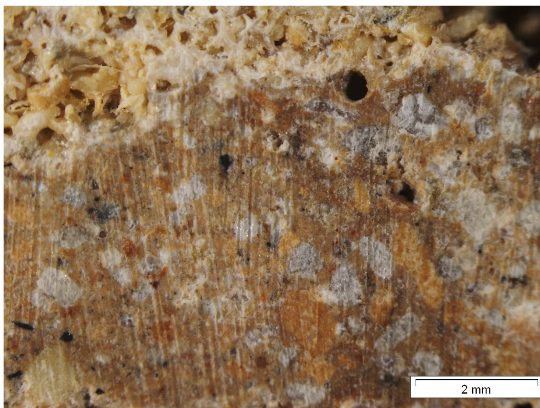
Figura 23.- Aspecto a la lupa binocular de la sección transversal de la muestra M10, en corte de sierra. Entre dos fragmentos pétreos se identifica capa de mortero granudo y compacto, de color pardo - marronáceo.
