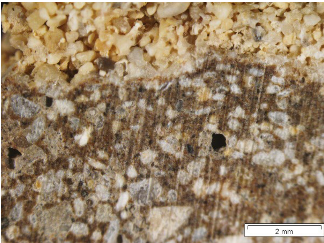
Figura 7.- Detalles a la lupa binocular de la sección transversal de la muestra MO-2. Destaca la textura compacta del mortero, frente al aspecto granudo bioclástico de la piedra de Marés.
