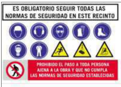
Ejemplo: Cartel de normas de seguridad en el acceso
