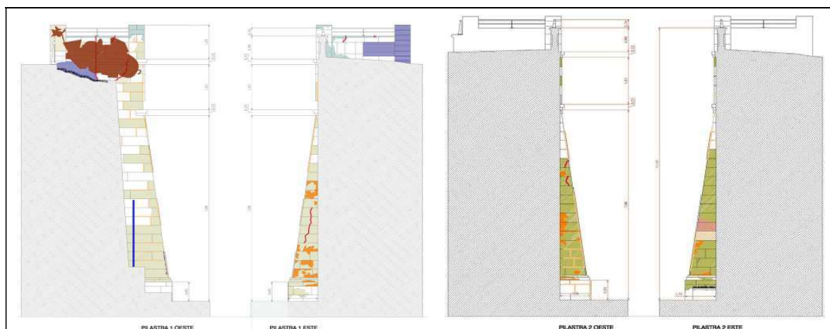
Alzado pilastra 1 y 2 con los principales agentes de degradación
