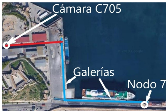
Ilustración 2. Canalizaciones existentes entre el Nodo 7 y la cámara C705.
