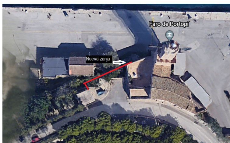
Ilustración 6. Nueva zanja desde el faro de Portopí hasta el edificio de la oficina exterior
