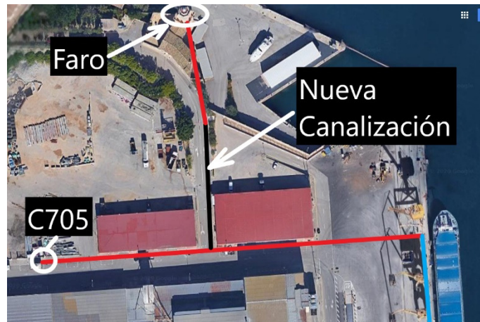
Ilustración 3. Zanja y nueva canalización (en negro)
