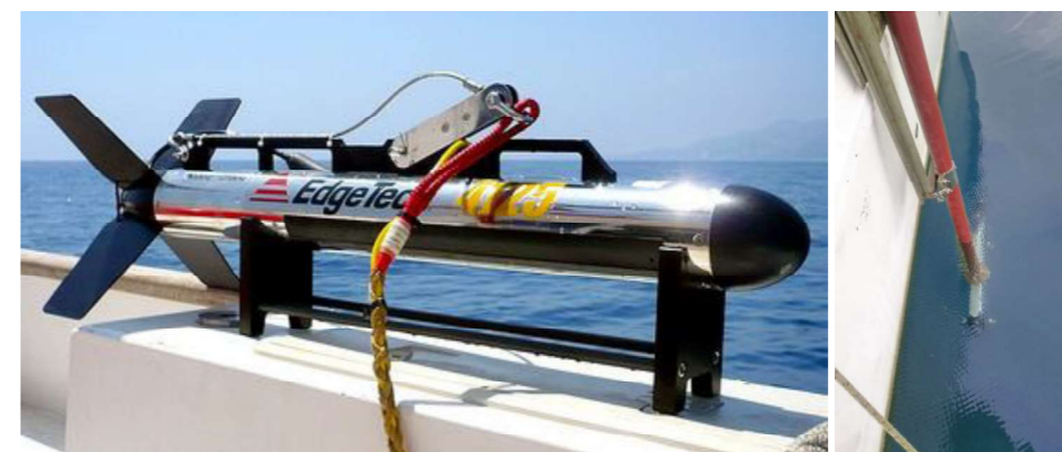
Figura 13. Sónar de Barrido Lateral Edgetech 4125 y montaje en el agua.
