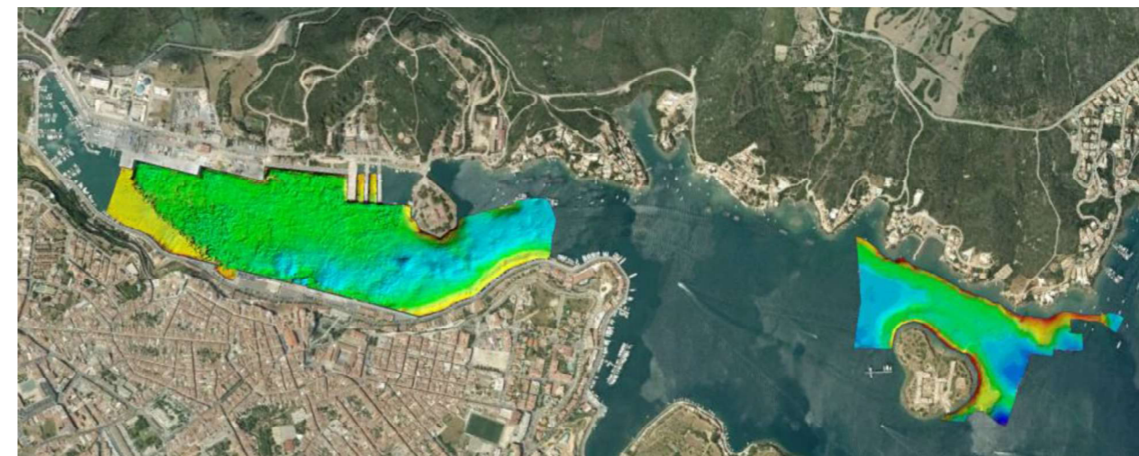
Figura 6. Recorrido batimétrico y batimetría obtenida del Puerto de Maó.
