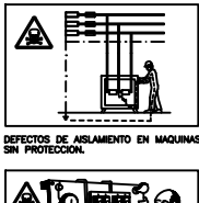
DEFECTOS DE AISLAMIENTO EN MAQUINAS SIN PROTECCION.
