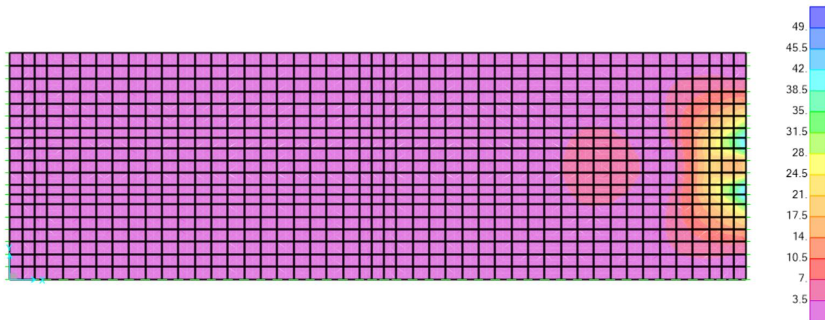
Figura 6.2 Distribución de esfuerzos cortantes en ELU04
