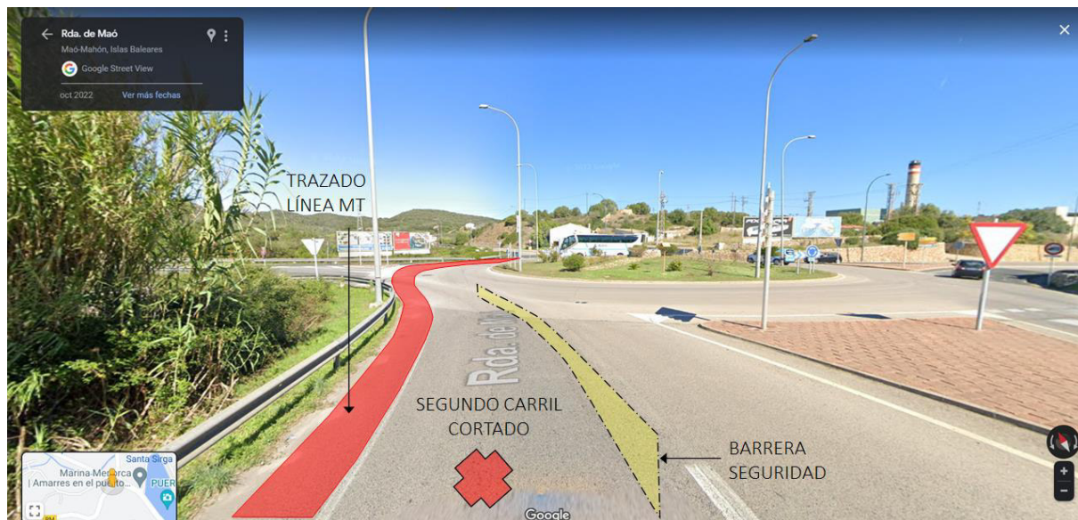
Figura 49. Punto 5 – Rotonda de acceso al puerto desde Ronda de Maó
