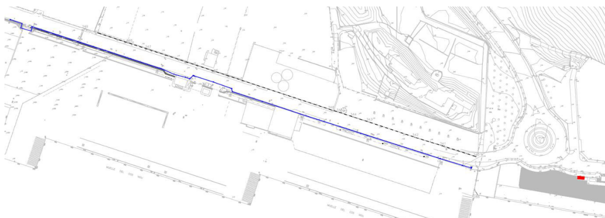
Figura 9. Plano Servicios Existentes de Electricidad
