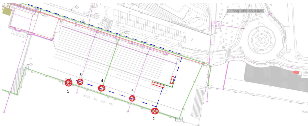
Figura 60. Servicios afectados en el Muelle del Cós Nou
