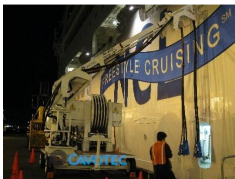
Figura 35. Pasar los cables hacia el barco
