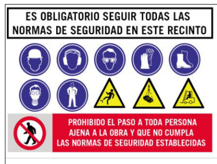
Ejemplo: Cartel de normas de seguridad en el acceso obras
