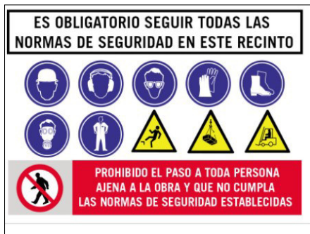
Ejemplo: Cartel de normas de seguridad en el acceso
