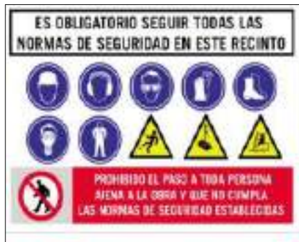
Ejemplo: Cartel de normas de seguridad en el acceso
