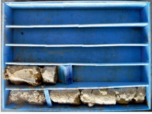
Fotografías 1 y 2: Cajas de testigos del sondeo 1
