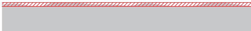
FRESADO DE REGULARIZACIÓN DE 5CM
