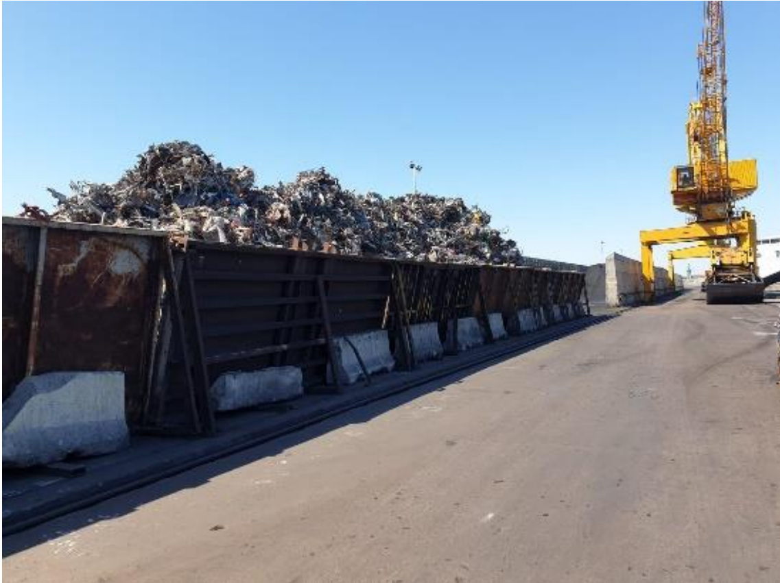
Ilustración 13 Área de acopio de chatarra, al fondo de hulla, con pantallas móviles
