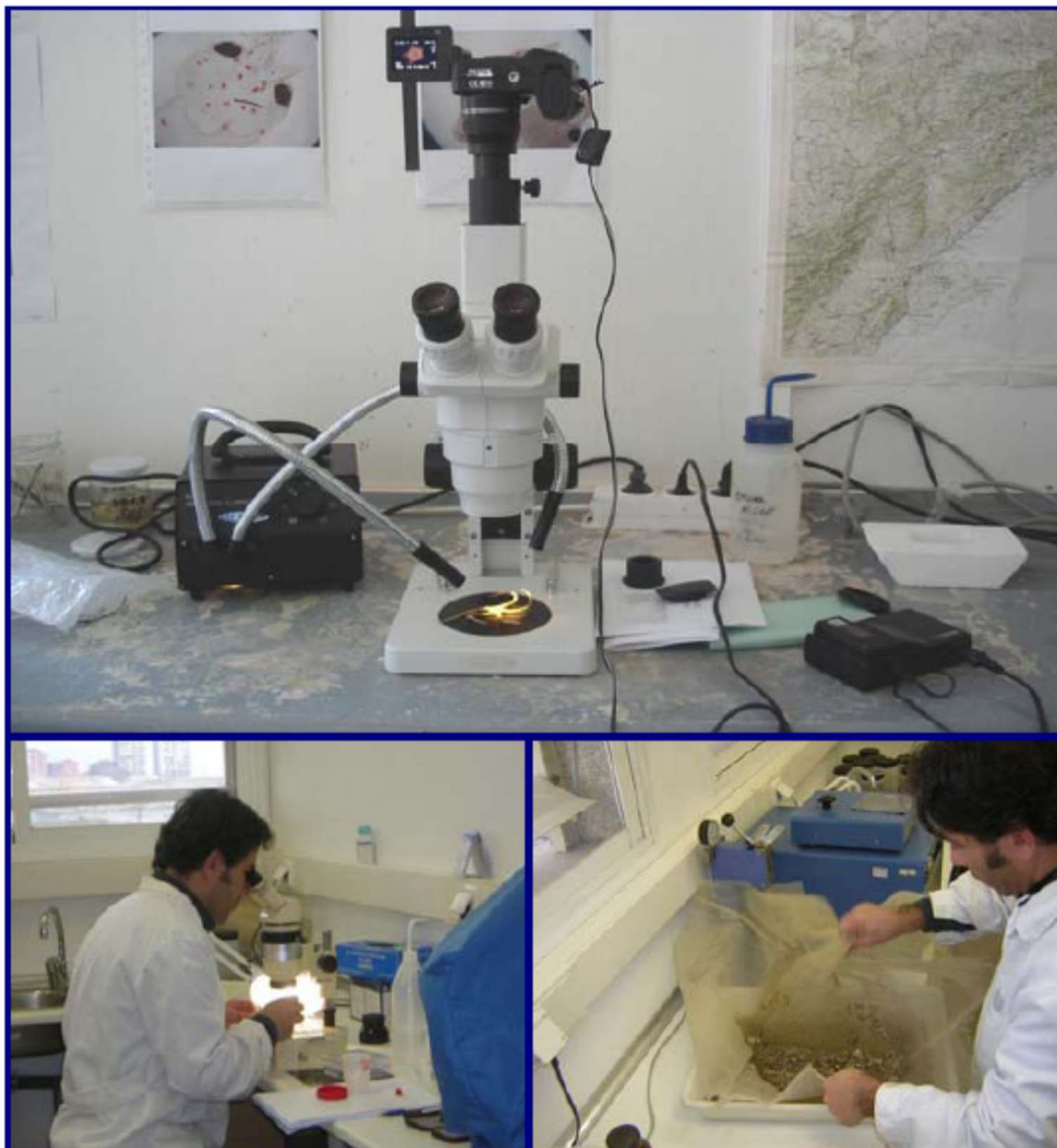
Figura 103.- Vista general del equipo de estereomicroscopía.
