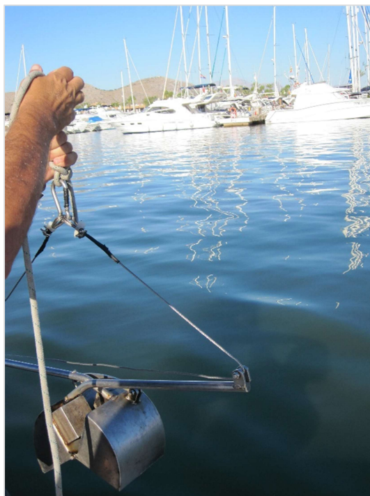
Figura 102.- Draga van ven en operación.
