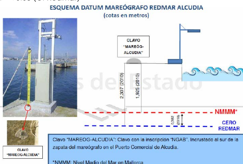
Figura 1.- Esquema de nivelación del mareógrafo de Alcudia.
