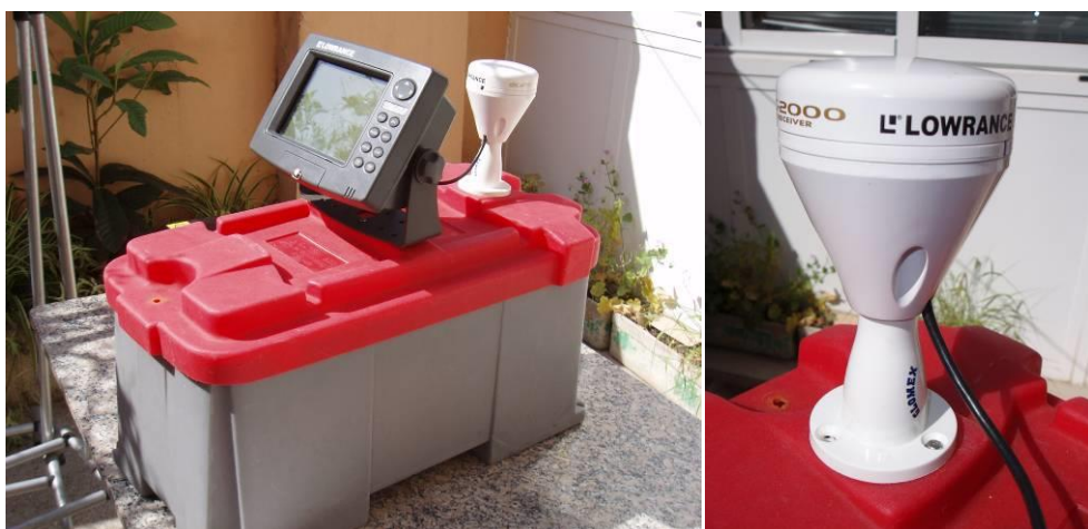
Figuras 2 a. y 2.b.- Equipo de sonda-GPS y plotter portátil utilizado para el levantamiento de la batimetría en el CMSAP. Detalle de antena de recepción señal Lowrance 2000.
