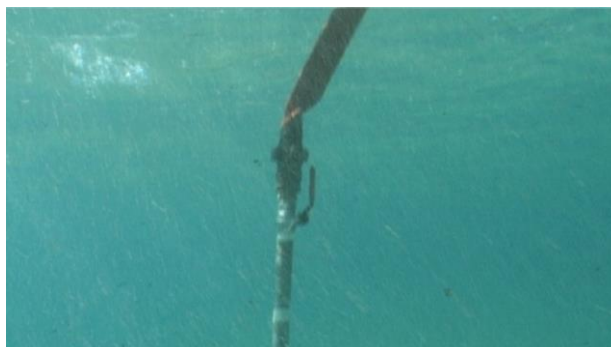
Figura 3 a y 3.b.- La lanza de 5m de longitud y 1' de diámetro viene marcada cada 20cm, es introducida manualmente en posición vertical por los buceadores para realizar la medición del material suelto (fangos, arenas, gravas)
