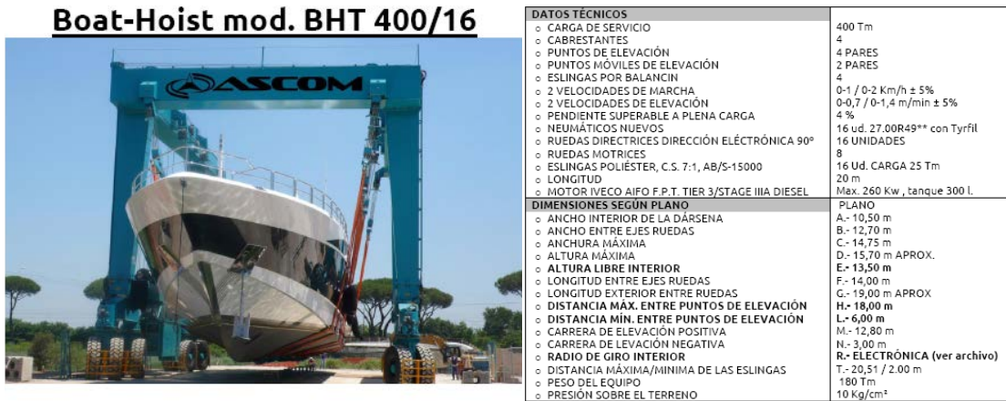
Figura 7.- Datos técnicos del Travelift de 400 Tn.
