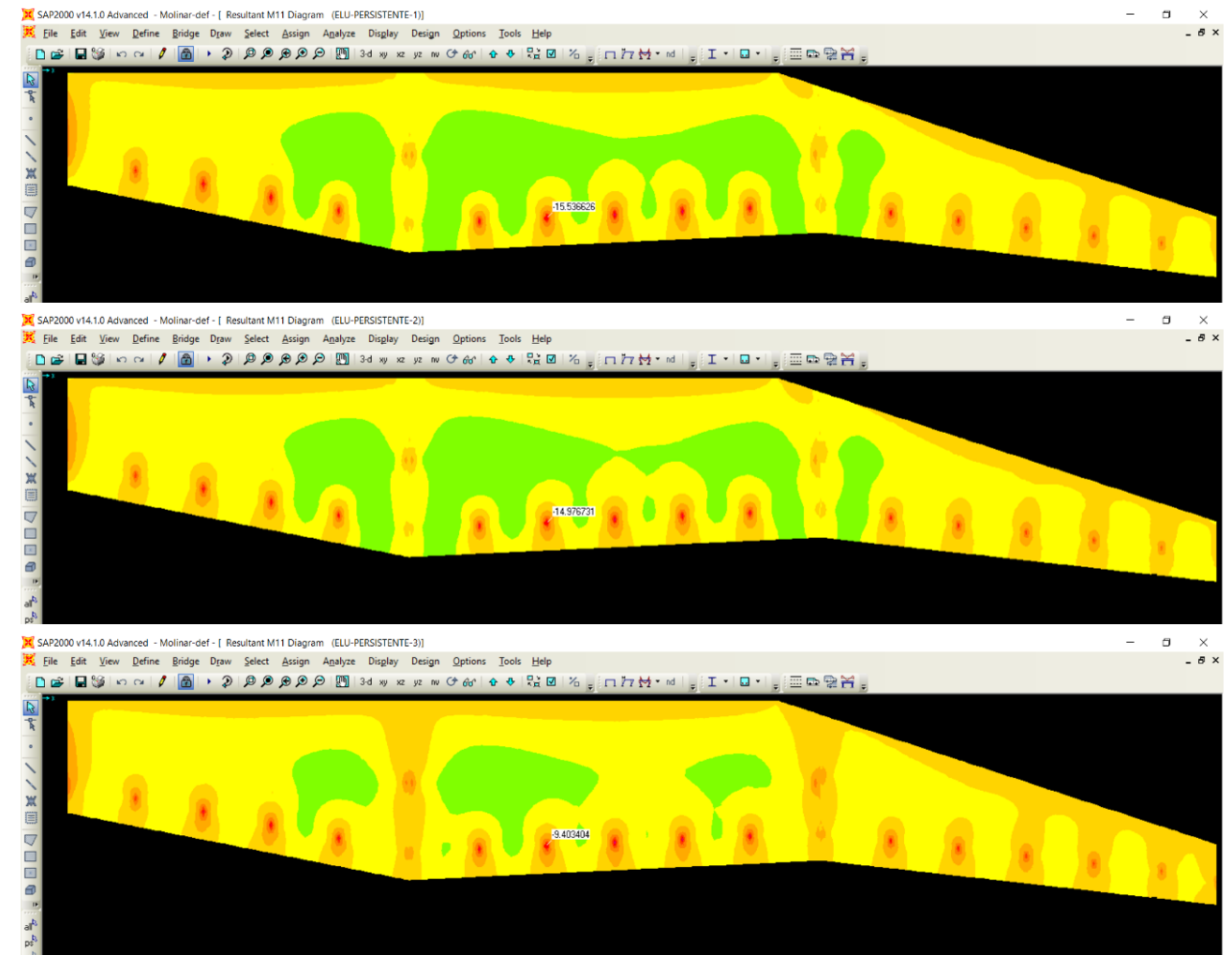
Momento flector de eje longitudinal M_{11} (txm/m). Persistentes 1-2-3
