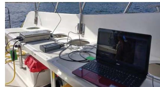
Figura 6: GPS Diferencial y equipos para la obtención, visualización y grabación en tiempo real de los sonogramas en campo. © OCEANSNELL
