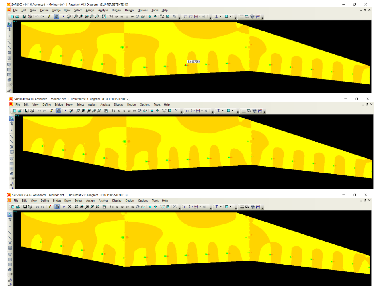
Esfuerzo cortante en dirección transversal V_{13} (t/m). Persistentes 1-2-3
