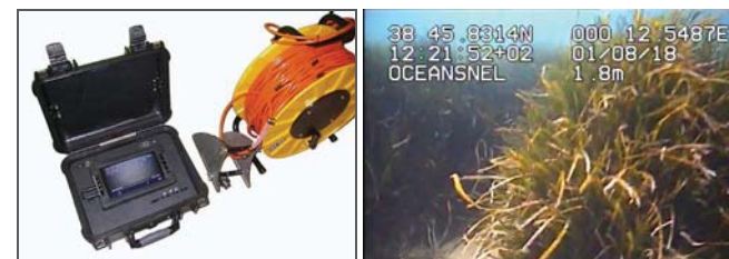
Figura 7: Equipo de TV remota georreferenciada e imagen georreferenciada obtenida. © OCEANSNELL.
