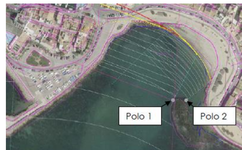
Figura 7. Análisis de la estabilidad en planta de la Cala del Portitxolet (Carlos Garau)
