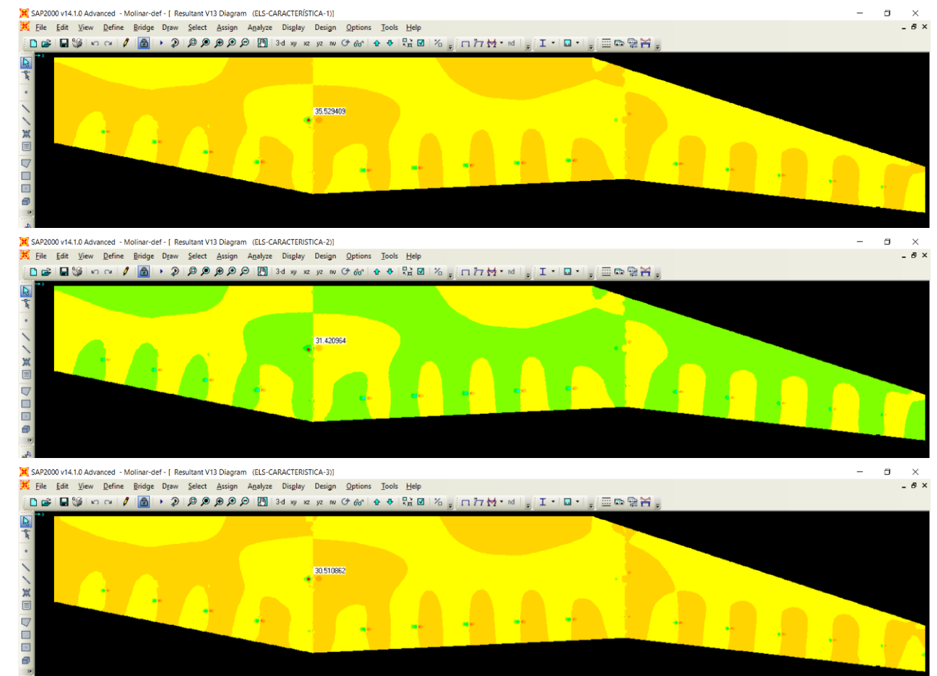
Esfuerzo cortante en dirección transversal V_{13} (t/m). Característica 1-2-3
