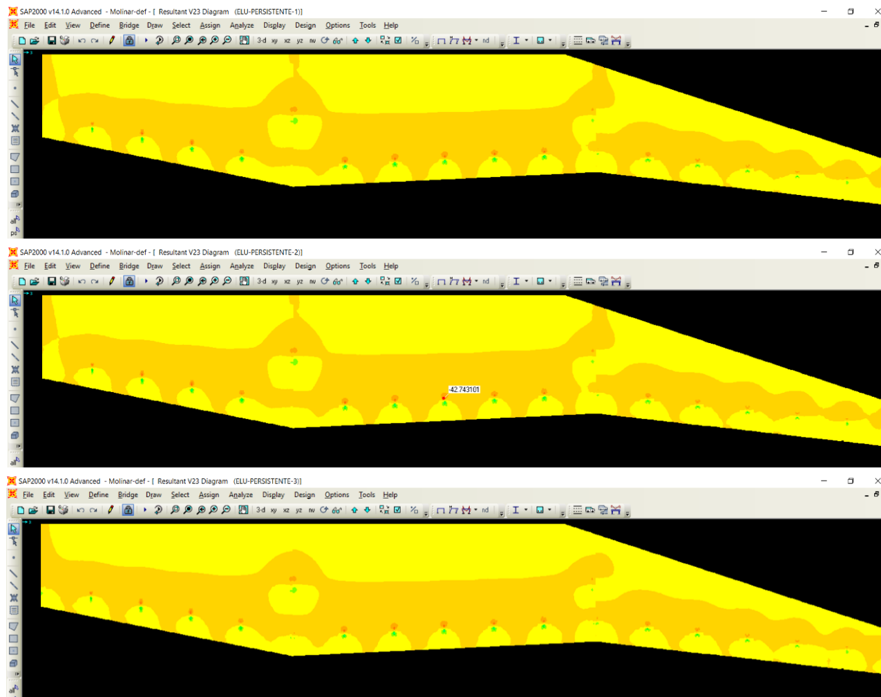
Esfuerzo cortante en dirección transversal V_{23} (t/m). Persistentes 1-2-3
