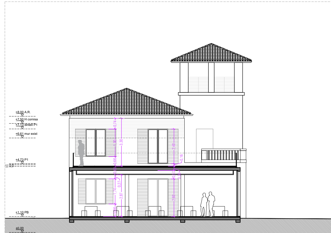
FACHADA ESTE - SECCIÓN TRANSVERSAL B
