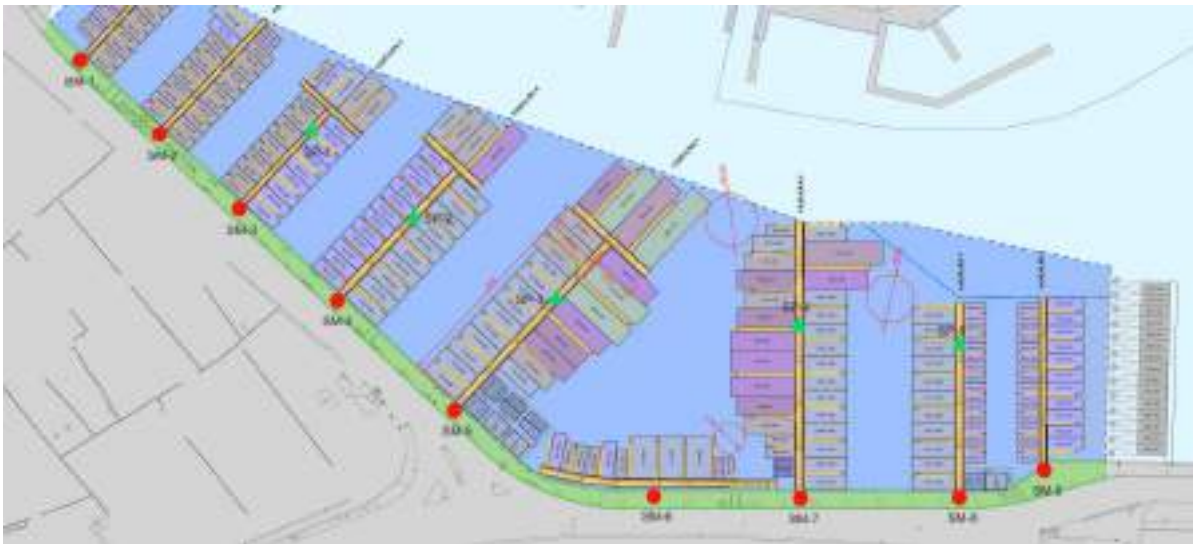
Figura 12.- Plano de sondeos propuesto para proyecto constructivo
