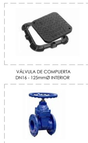
ARQUETA KIO 400 POLIECO C250 EN124-5 Medida marco 400x400 - tapa 335x335mm
