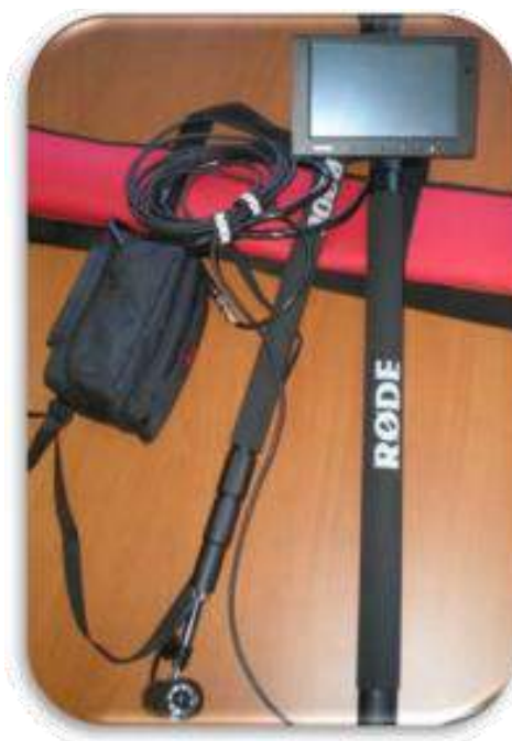
Figura 16.- Detalle del equipo de inspección portátil de MAREXI modelo MAI03.
