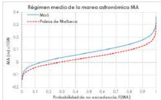
Figura 12.- Régimen medio de la marea astronómica (MA) en los mareógrafos de Palma y de Maó (Fuente: PPEE)
