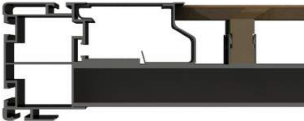
Figura 7.- Detalle de la sección de la galería de servicios en los pantalanes flotantes.
