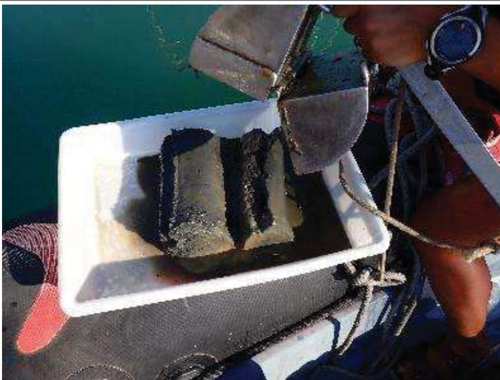
Figura 2.- Detalle de la recogida de muestras de sedimento con una draga tipo Van Veen.
