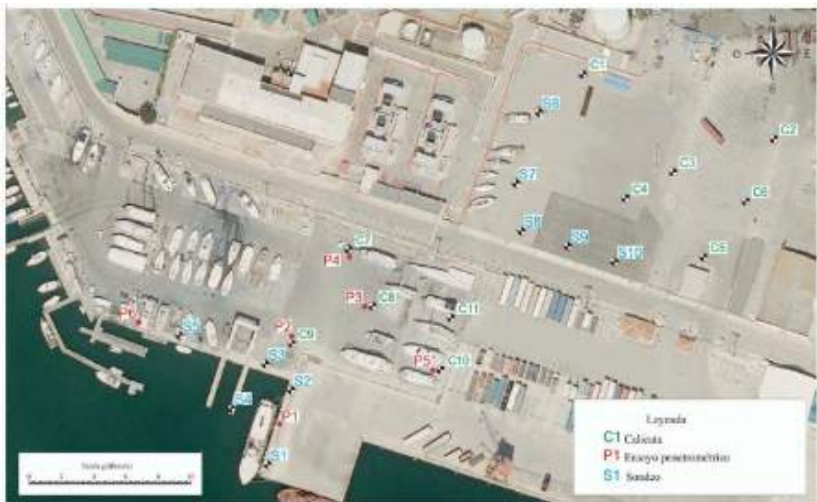
Figura 11.- Situación puntos de reconocimiento en el Muelle de Cos Nou
