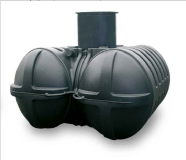
DEPÓSITO ROTH TWINBLOCK CAPACIDAD 5.000 L 2.460x2.350x1.350 mm COLOCACIÓN 8 DEPÓSITOS EN PARALELO VOLUMEN TOTAL 40m 3
