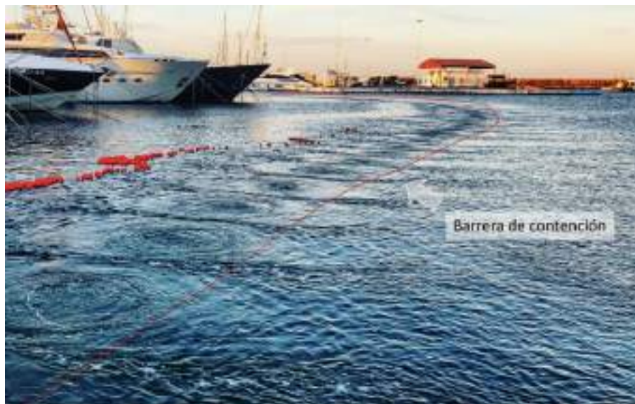
Figura 33.- Detalle de las barreras de contención 02 Marine de Equiport.
