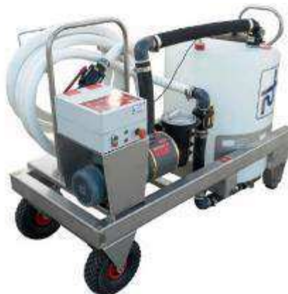
Figura 3. Equipo para retirada de aguas de sentina y aguas grises (Fuente: EQUIPORT)
