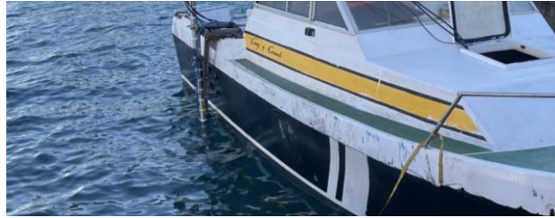
Figura 3. Ecosonda multihaz instalada en el costado de estribor de la embarcación.
