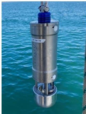
Figura 7. Sonda de velocidad del sonido Swift SVP (Valeport).
