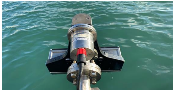
Figura 4. Unidad de medición inercial IMU POSMV V5 de Applanix instalada sobre la ecosonda multihaz.
