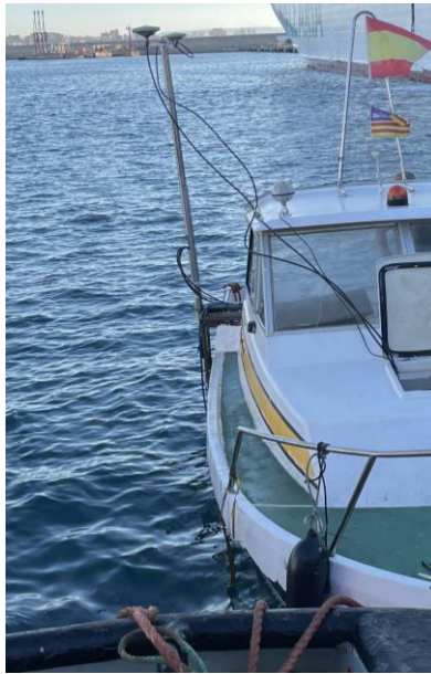
Figura 5. Antenas GNSS-RTK instaladas sobre la barra de la ecosonda multihaz.
