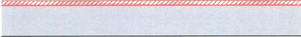
FRESADO DE REGULARIZACIÓN DE 5CM
