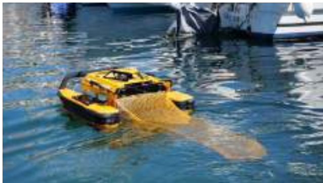
Figura 35. Sistema de recogida de residuos flotantes autónomo
