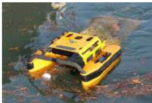
Figura 35. Sistema de recogida de residuos flotantes autónomo
