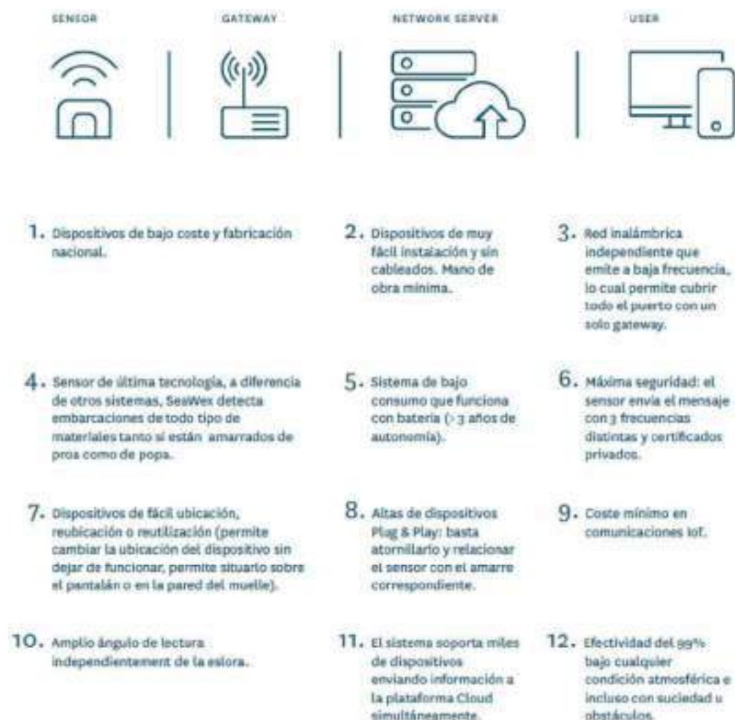
Imagen 7. Características principales del Sensor Seawex a instalar
