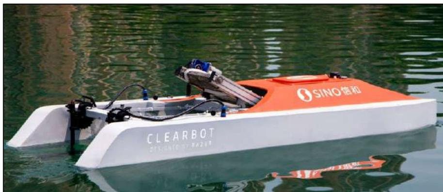
Roza la superficie y recoge la basura flotante en una cinta transportadora a bordo instalada cerca de su proa, entre sus cascos dobles, y en un contenedor cerca de su popa.
