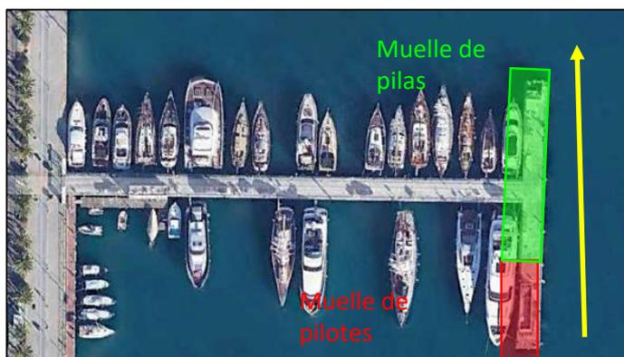
En esta segunda alineación, existen 2 tipologías de muelle. Siguiendo el sentido de la flecha de la imagen anterior, al principio disponemos de un muelle de pilotes. Los pilotes y los encepados presentan buen estado, como se puede observar en el **vídeo Nº 11**.
