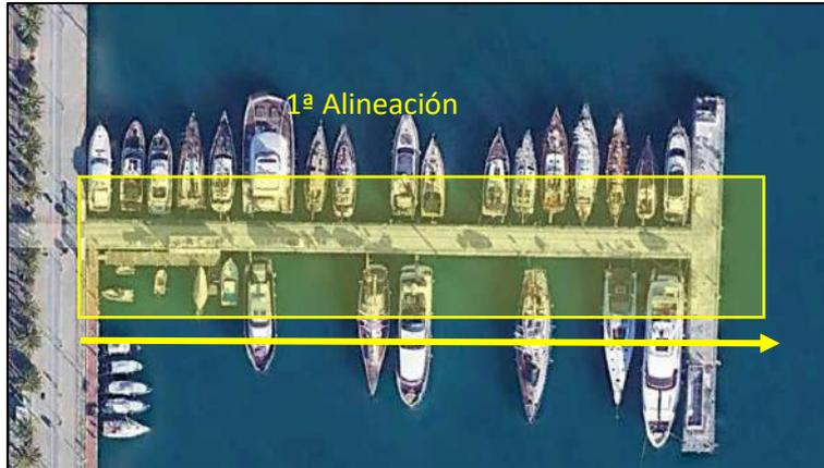
En esta primera alineación, la tipología de este pantalán está formada mediante pilas y losa de hormigón apoyada sobre vigas. En total hay 8 vanos.
