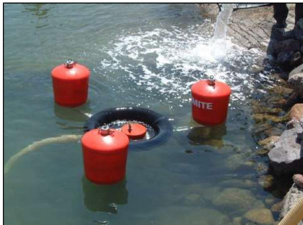
Flow' flota independientemente del skimmer debido a sus conexiones flexibles y a su masa inerte extremadamente baja por lo que permanece en todo momento paralelo a la superficie de contacto agua/hidrocarburo.
