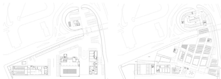
*Figura 4.1.3 – Estado actual (izquierda) y estado reformado, nuevo, (derecha) de la planta baja del complejo*
